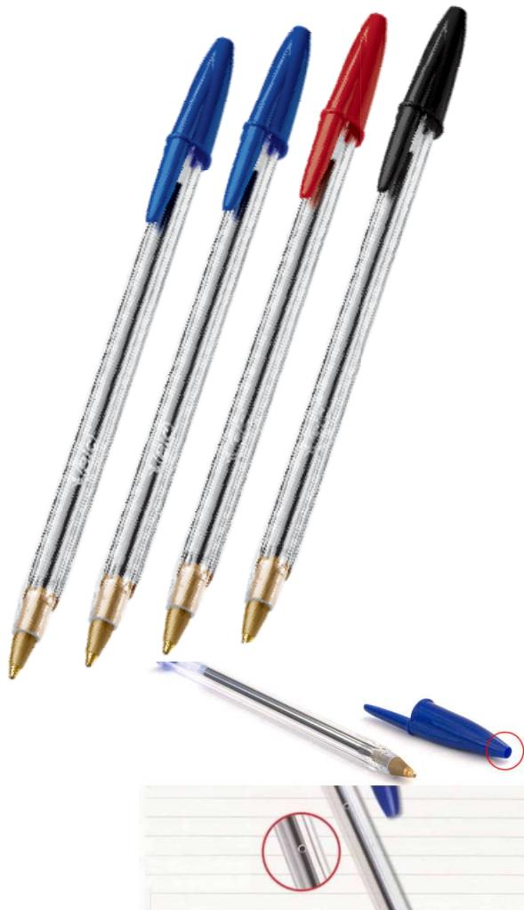
**Corpo:** transparente em poliestireno, sextavado, possui furo na lateral do corpo para equilíbrio das pressões externa e interna da caneta.
